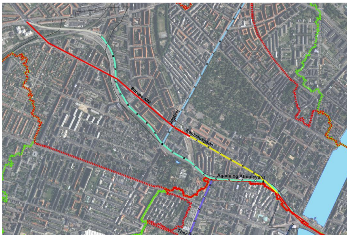
Figur 22 Alternativ linjeføring for tunnel under Åboulevarden er vist med gult. Tunnelen anlægges under Borups Allé, Rantzausgade og den østligste del af Åboulevarden. Den fuldoptrukne røde streg angiver, hvor tunnelen udformes som vist på tunnelsektionen i afsnit 8.2. Den fuldoptrukne gule streg angiver, hvor det pga. af meget begrænsede pladsforhold er nødvendigt at placere de 2 tunnelrør for udadgående og indadgående trafik oven på hinanden.
