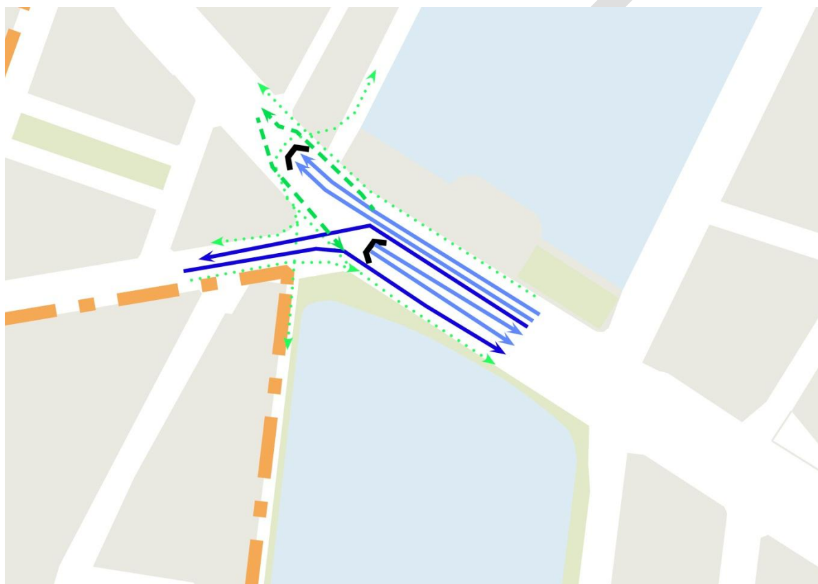
Figur 12 Mulig udformning af tunnelstart og ophør ved Søsnettet
