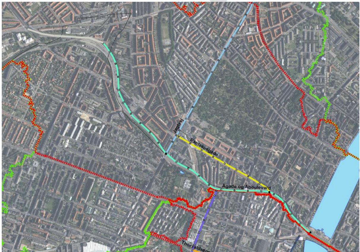
Figur 17 Linjeføringen for Åboulevard, Ågade og Bispebuen er vist med turkis farve. De sorte og hvide prikker på linjeføringen er stationerings mærker med en indbyrdes afstand på 100 m startende fra søerne. Jagtvej krydser med stationering +1300. Linjeføringen er ca. 2800 m lang.
